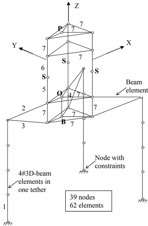
**Fig. 2.** Finite element model of mini TLP
