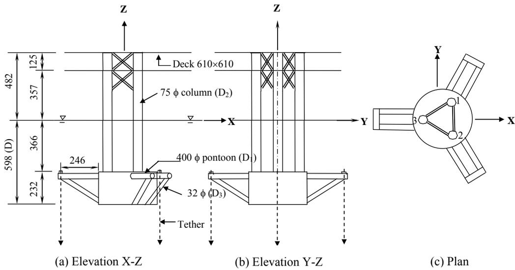
Fig. 1. Three-column mini TLP model (scale 1:56)
